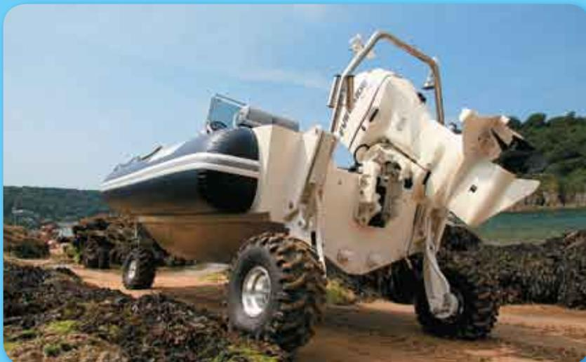
Амфибия RAC представляет собой лодку с жестким днищем и надувными бортами (тип RIB), оборудованную подвесным двигателем для передвижения по воде и небольшим мотором для движения по суше при помощи оригинального выдвигного приводного шасси. Для различных спасательных служб типа RED RESCUE существует версия с цельнометаллическим корпусом (алюминий, нержавеющая сталь). Интересно, что военные предпочитают амфибии с корпусом типа RIB - очевидно за более низкий вес.
